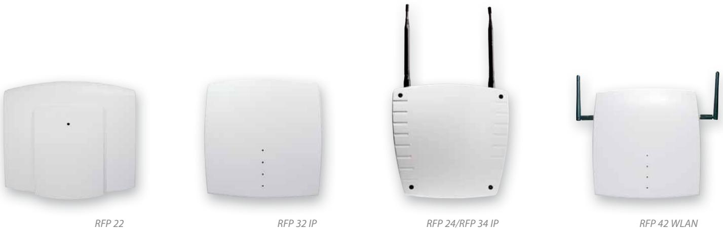
**Die DECT-Basisstationen bilden die Grundbausteine für den Ausbau eigener DECT-Funknetze an OpenCom-100-Systemen. Jede dieser Stationen bildet im DECT-Funknetz eine eigene Zelle mit einer Reichweite von bis zu 300 m. Zur Auswahl stehen Basisstationen für den Anschluss an die klassische 2-Draht-Leitung (DECT) oder für das IP-Netzwerk (DECToverIP).**
